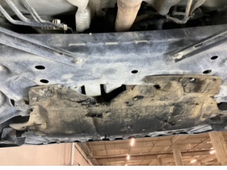
Motor, Alt muhafaza > Hasarlı
