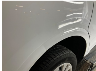
Çamurluk, sağ arka, Çamurluk, sağ arka > Ezik
