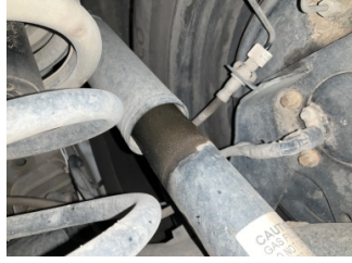
Arka aks, Amortisör, arka sağ > Yağ Kaçağı
