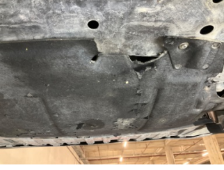
Motor, Alt muhafaza > Hasarlı
