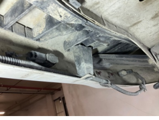
Tampon, arka, Bağlantı ayağı > Kırılmış
