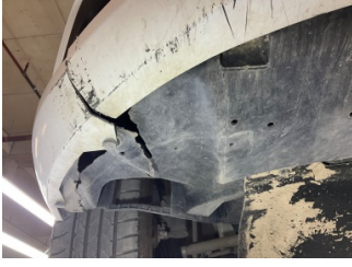
Tampon, ön, Tampon koruyucu orta > Hasarlı
