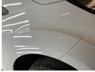
Çamurluk, sağ, Çamurluk, sağ > Taş İzi
