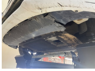
Motor, Alt muhafaza > Hasarlı
