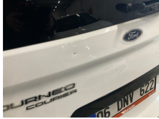
Bagaj kapağı/kapısı, Bagaj kapısı > Noktasal Ezik
