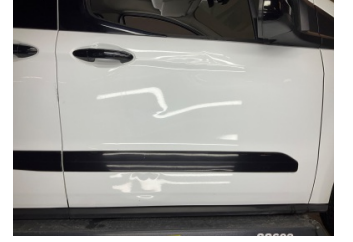
Kapı, sağ ön, Kapı, sağ ön > Hasarlı
