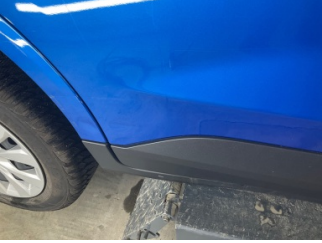
Kapı, sağ arka, Kapı, sağ arka > Ezik
