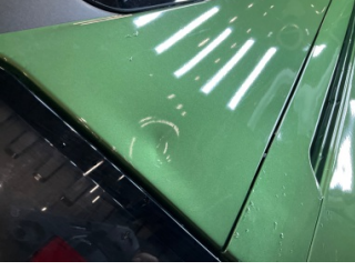
Çamurluk, sağ arka, Çamurluk, sağ arka > Ezik
