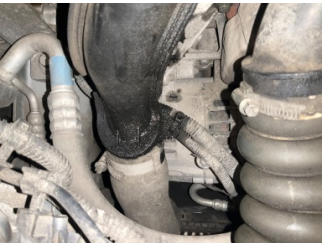
Motor, Turbo hortumları > Yağ Kaçağı
