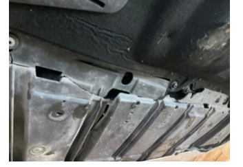
Tampon, ön, Tampon koruyucu orta > Hasarlı
