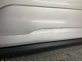
Kapı, sol ön, Kapı, sol ön > Çizik
