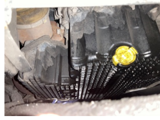
Motor, Yağ karteri > Yağ Kaçağı
