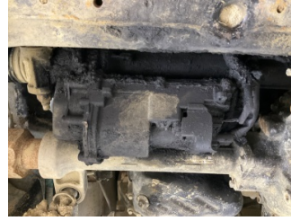
Motor, Marş motoru > Yağ Kaçağı
