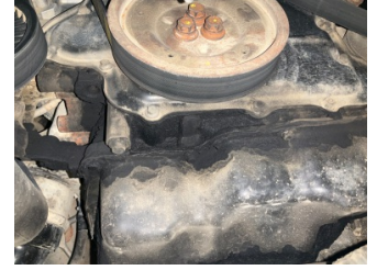
Motor, Motor > Yağ Kaçağı
