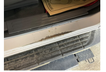
Marşbiyel, sağ, Marşbiyel, sağ > Pas
