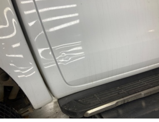
Kapı, sağ arka, Kapı, sağ arka > Ezik
