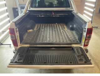
Döşemeler/Kapaklar, Yükleme eşiği kaplaması > Ezik
