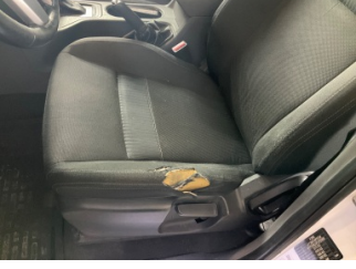
Koltuklar, ön, Koltuk döşemesi, sol ön > Hasarlı
