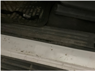
Kapı, sol ön, Kapı fitili > Hasarlı
