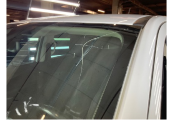
Camlar, Ön cam > Hasarlı
