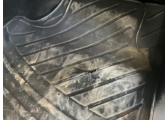
Taban, Paspaslar > Deforme Olmuş
