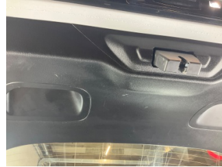
Döşemeler/Kapaklar, Döşemeler/Kapaklar > Deforme Olmuş
