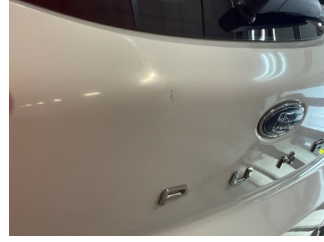
Bagaj kapağı/kapısı, Bagaj kapısı > Noktasal Ezik
