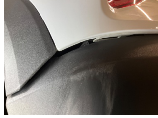
Tampon, arka, Spoyler > Sabitlemesi Hatalı
