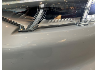
Tampon, ön, Ön tampon > Sabitlemesi Hatalı
