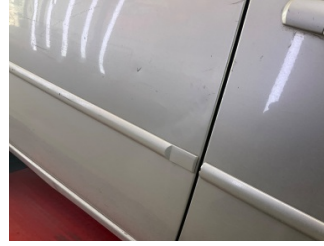
Kapı, sağ arka, Kapı, sağ arka > Ezik
