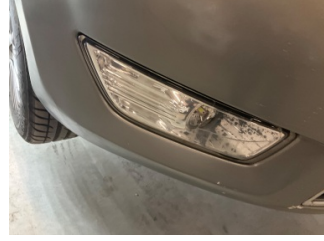
Sis lambaları, Sis farı camı, sağ > Hasarlı
