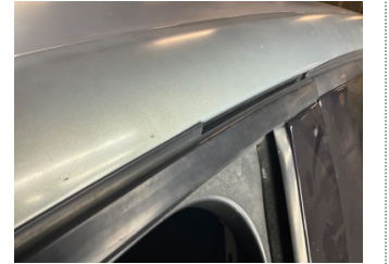
Kapı, sol ön, Cam sıyrıcı fitili, dış > Hasarlı
