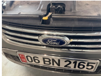
İlave parçalar, ön, Ön panjur > Deforme Olmuş
