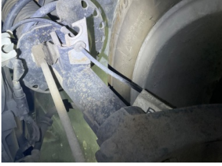
Ön aks, Denge çubuğu, bağlantı cubuğu sağ > Hasarlı
