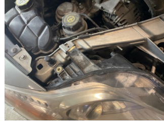
Farlar, Far bağlantı ayağı, sağ > Hasarlı
