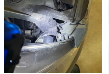
Farlar, Far bağlantı ayağı, sağ > Hasarlı
