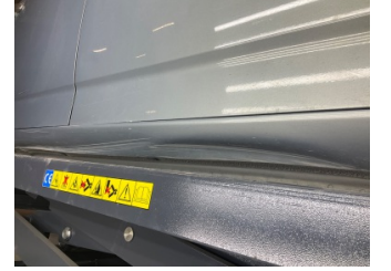
Marşbiyel, sağ, Marşbiyel, sağ > Hasarlı
