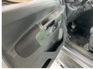
Döşemeler/Kapaklar, Döşemeler/Kapaklar > Deforme Olmuş
