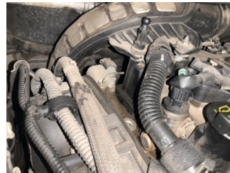
Motor, Motor > Yağ Kaçağı
