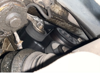
Motor, Motor > Yağ Kaçağı
