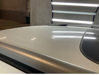
Tavan, Tavan > Dolu Hasarı
