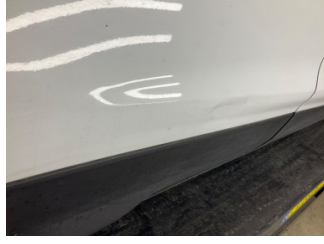
Kapı, sağ arka, Kapı, sağ arka > Ezik
