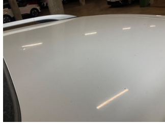
Tavan, Tavan > Dolu Hasarı
