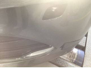
Tampon, ön, Far yıkama sistemi > Hasarlı
