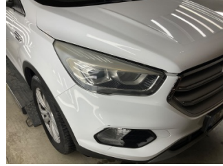
Farlar, Far camı, sağ > Deforme Olmuş
