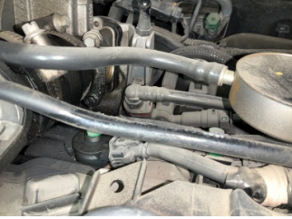
Motor, Turbo hortumları > Yağ Kaçağı
