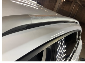
Tavan, Rüzgar engelleyici > Deforme Olmuş
