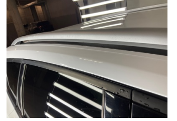
Tavan, Rüzgar engelleyici > Deforme Olmuş
