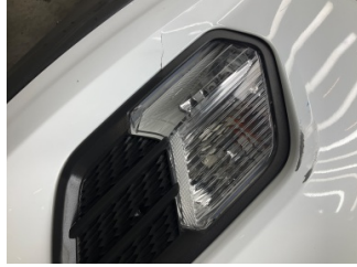
Tampon, ön, Ön tampon > Kırılmış
