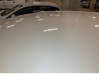
Tavan, Tavan > Dolu Hasarı
