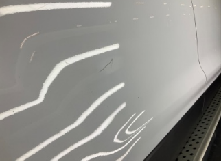
Kapı, sağ arka, Kapı, sağ arka > Çizik
