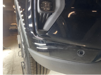
Tampon, ön, Ön tampon > Yüzey Çizik
