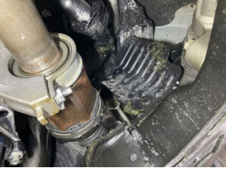
Ön aks, Aks mili, sağ > Yağ Kaçağı
