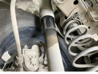
Arka aks, Amortisör, arka sol > Yağ Kaçağı
