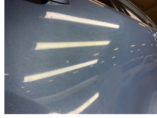
Kapı, sağ arka, Kapı, sağ arka > Ezik
