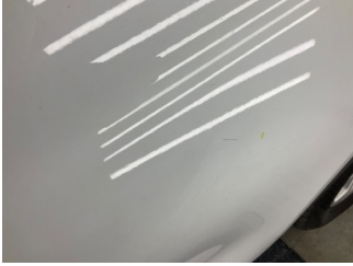
Kapı, sol arka, Kapı, sol arka > Çizik
