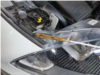
Motor, Yağ seviyesi > Eksik
