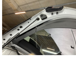
Döşemeler/Kapaklar, Bagaj bölümü döşemesi > Sabitlemesi Hatalı
