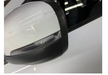
Dikiz aynası, sol, Sinyal lambası > Çatlak
