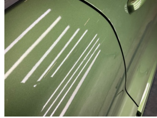
Kapı, sağ arka, Kapı, sağ arka > Çizik
