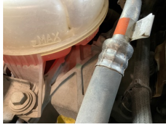
Motorsoğutması, Soğutma sıvısı > Eksik
