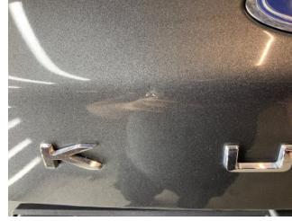
Bagaj kapağı/kapısı, Bagaj kapısı > Noktasal Ezik
