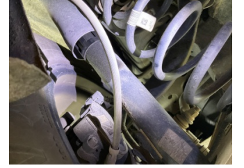
Arka aks, Amortisör, arka > Yağ Kaçağı
