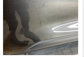
Kapı, sağ arka, Kapı, sağ arka > Çizik
