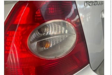
Arka lambalar, Arka lamba camı, sol > Çatlak
