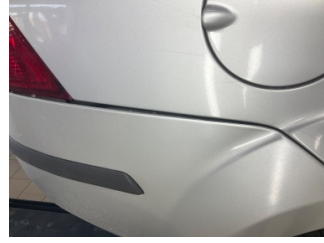
Tampon, arka, Bağlantı ayağı > Sabitlemesi Hatalı
