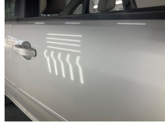
Kapı, sağ ön, Kapı, sağ > Noktasal Ezik
