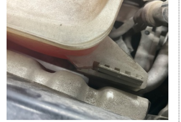
Motorsoğutması, Genleşme kabı > Hasarlı
