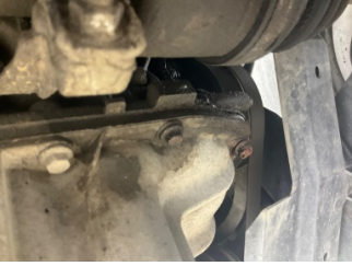
Motor, Motor > Yağ Kaçağı
