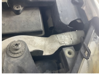
Kaporta, Ön Panel > Hasarlı
