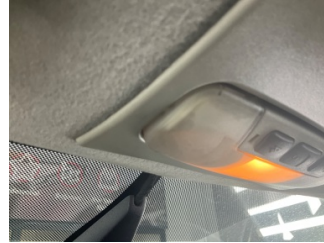
Elektrik donanımı/Pano, Okuma lambası, sol > Deforme Olmuş
