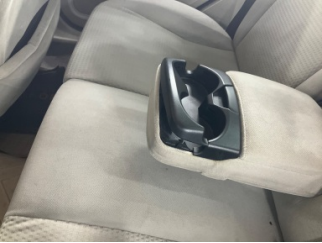
Koltuklar, arka, Arka koltuk, kol dayaması > Hasarlı
