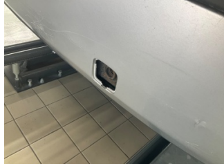
Tampon, arka, Çeki demir kapağı > Sökülmüş-Yok
