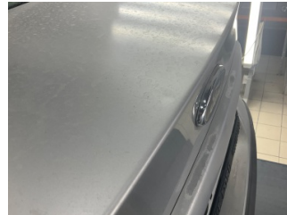
Bagaj kapağı/kapısı, Bagaj kapısı > Noktasal Ezik
