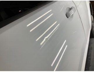
Kapı, sol ön, Kapı, sol ön > Ezik
