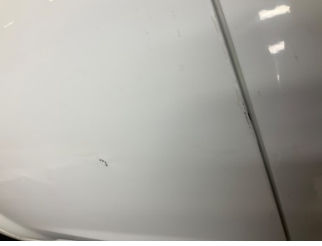
Kapı, sağ arka, Kapı, sağ arka > Ezik
