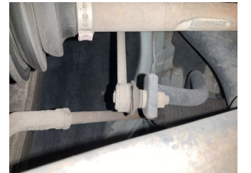
Direksiyon sistemi, Rot kolu/Rot başı, sağ > Hasarlı
