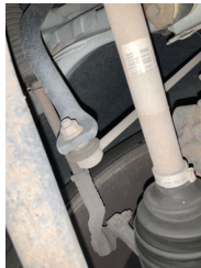
Direksiyon sistemi, Rot kolu/Rot başı, sol > Hasarlı
