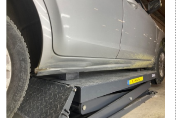
Marşbiyel, sağ, Marşbiyel, sağ > Hasarlı
