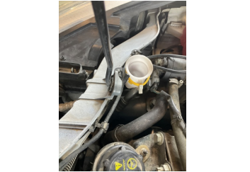
Cam yıkama/silme sistemi, Cam suyu bidonu kapağı > Sökülmüş-Yok
