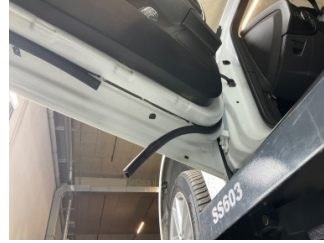
Kapı, sol ön, Kapı fitili > Sabitlemesi Hatalı
