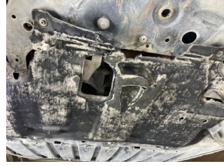
Motor, Alt muhafaza > Hasarlı
