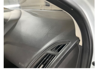
Pano/Göstergeler, Ön Torpido > Deforme Olmuş
