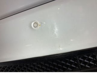
Tampon, arka, Arka tampon > Boyası Atmış
