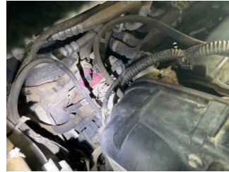
LPG/CNG sistemi, Regülatör > Sızdırıyor
