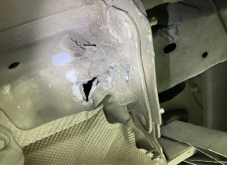
Kaporta, Sol Arka Şase > Standart Dışı Onarım
