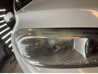
Farlar, Far camı, sağ > Deforme Olmuş
