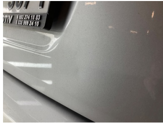
Bagaj kapağı/kapısı, Bagaj kapısı > Ezik
