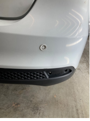
Tampon, arka, Reflektör, sağ > Sökülmüş-Yok
