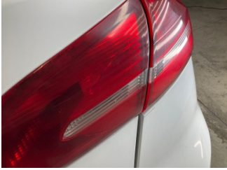
Arka lambalar, Arka lamba camı, sağ > Çatlak
