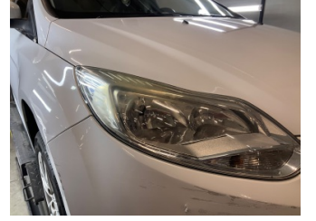
Farlar, Far camı, sağ > Deforme Olmuş
