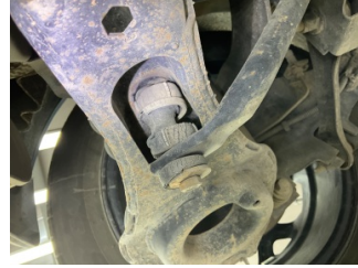
Arka aks, Aks gövdesi, arka > Hasarlı
