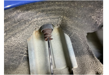
Arka aks, Amortisör körüğü, sol > Hasarlı
