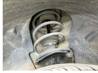
Ön aks, Amortisör körüğü, sağ > Hasarlı
