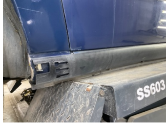
Marşbiyel, sol, Marşbiyel plastiği, sol > Hasarlı
