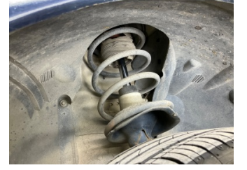
Ön aks, Amortisör körüğü, sol > Hasarlı
