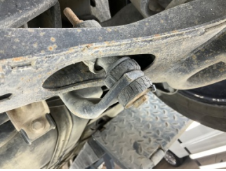
Arka aks, Aks gövdesi, arka > Hasarlı
