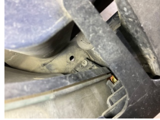
Farlar, Far bağlantı ayağı, sağ > Hasarlı
