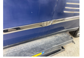
Kapı, sol ön, Nikelaj, alt > Hasarlı
