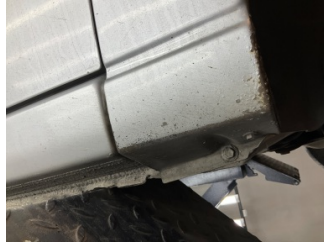
Çamurluk, sağ, Çamurluk, sağ > Boyası Atmış
