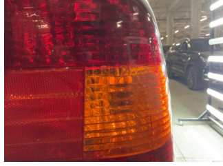
Arka lambalar, Arka lamba camı, sağ > Çatlak
