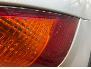
Arka lambalar, Arka lamba camı, sağ > Çatlak
