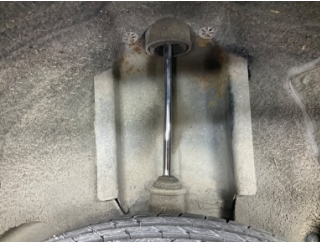
Arka aks, Amortisör körüğü, sol > Hasarlı
