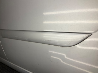
Kapı, sol arka, Kapı bandı > Çizik
