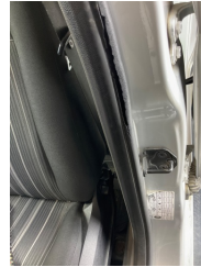
Kapı, sol ön, Kapı fitili > Hasarlı
