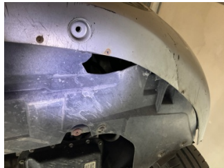
Tampon, ön, Tampon koruyucu orta > Hasarlı
