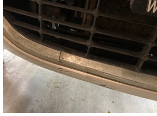
Tampon, ön, Ön tampon ızgarası > Hasarlı
