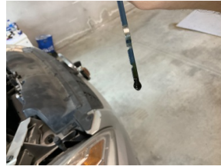
Motor, Yağ seviyesi > Eksik
