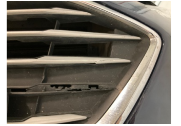
Tampon, ön, Ön tampon ızgarası > Hasarlı
