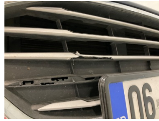
Tampon, ön, Ön tampon ızgarası > Hasarlı
