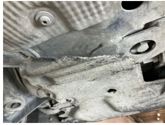
Motor, Alt muhafaza > Hasarlı
