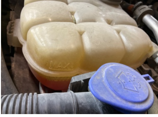
Motorsoğutması, Soğutma sıvısı > Eksik
