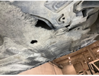
Motor, Alt muhafaza > Hasarlı
