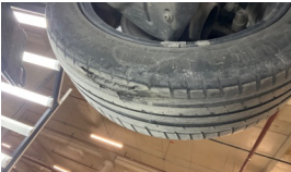
Lastik, sol arka > Hasarlı
