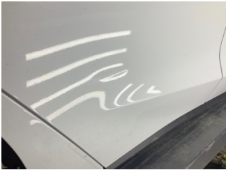
Kapı, sağ arka, Kapı, sağ arka > Ezik
