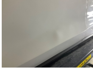
Kapı, sol  n, Kapı, sol  n > Ezik
