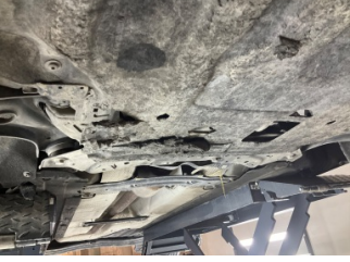
Motor, Alt muhafaza > Hasarlı
